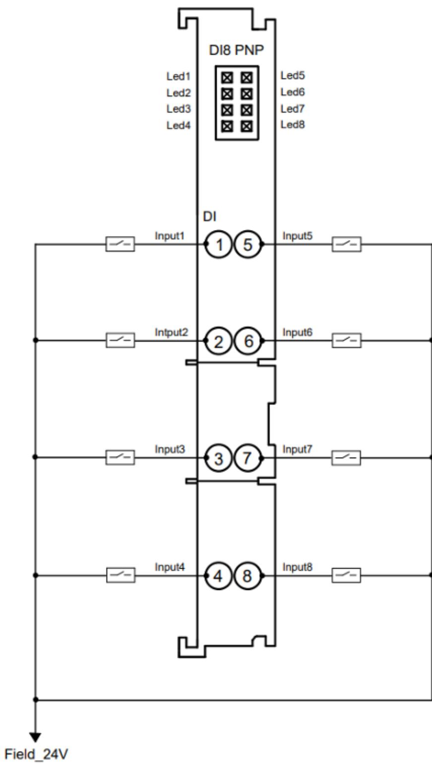
\*负载电源需与前端电源模块现场侧电源为同一电源。
