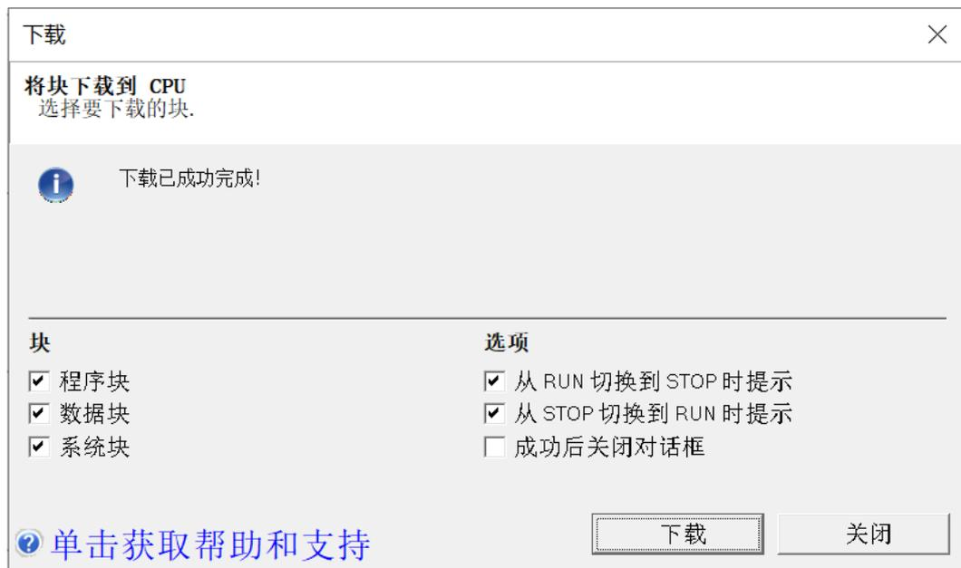
注：下载完成后，将模块重新上电处理。
